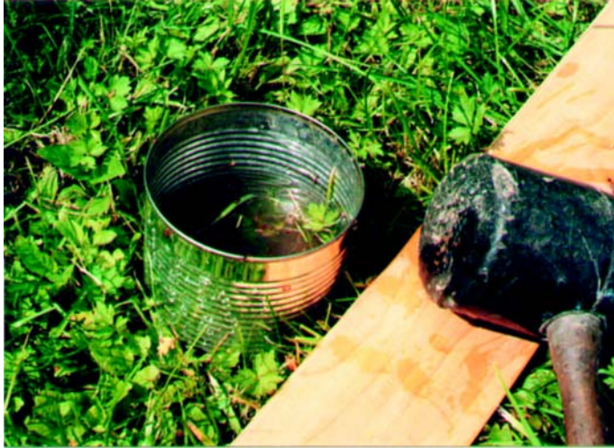
Abb. 12: Wasser versickert in der in den Boden gerammten Konservendose
